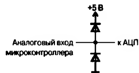
Рис. 37. Защита входов АЦП микроконтроллера от перенапряжения
